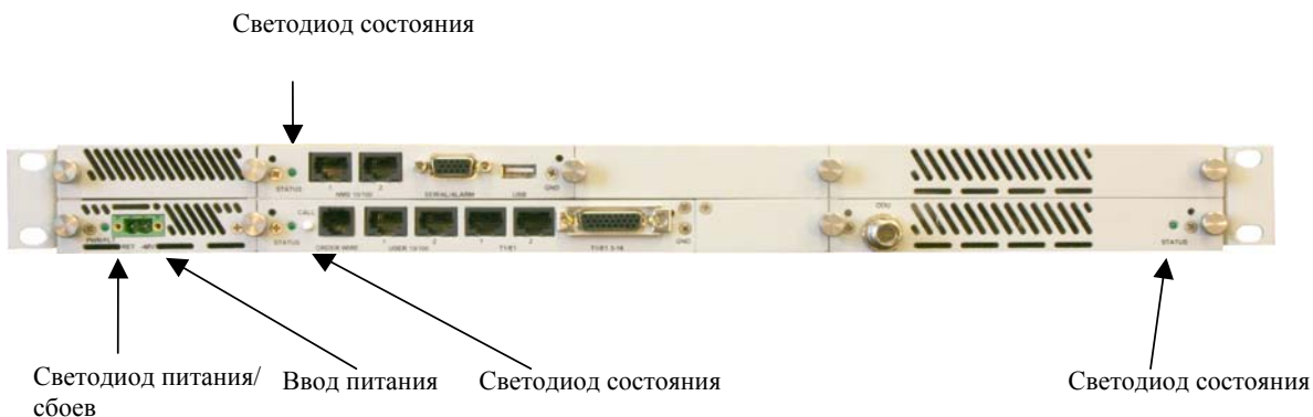
Рис. 2.2. Светодиоды передней панели внутреннего блока CFQ-SD, конфигурация 1+0.
